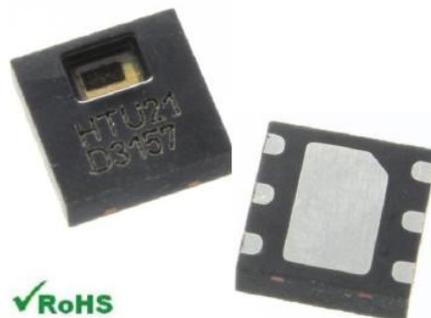
HTU21D是法国Humirel 公司推出的一款电容式相对湿度传感器，采用双列扁平无引脚DFN封装，底面3x3mm，高度1.1mm。传感器输出经过标定的数字信号，标准 I2C 格式。
